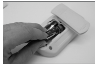
Figuur 3-3 De batterijen plaatsen
